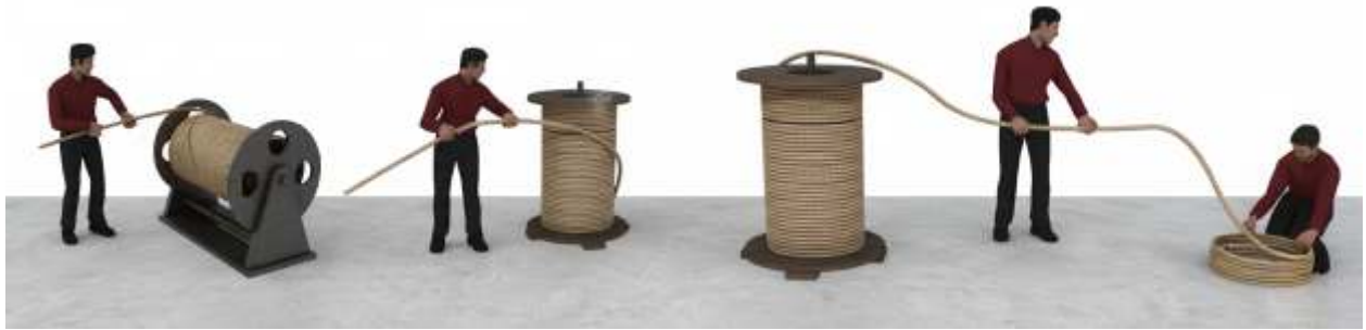
Fig. 29 : Unreeling a New Wire Rope
